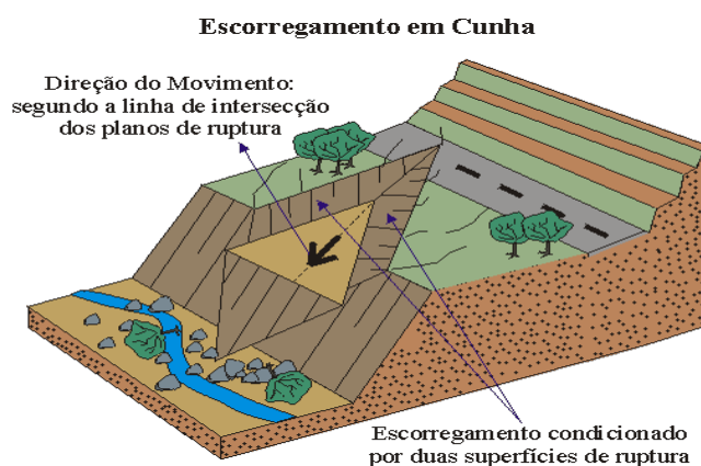
Figura 18 - Esquema de deslizamento em cunha.
