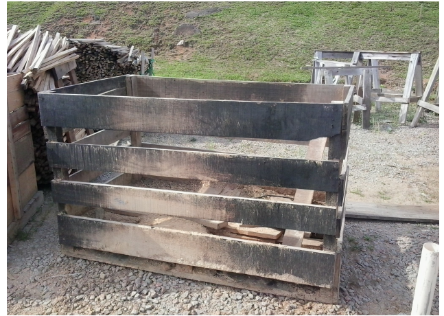
b) Caixa de madeira içada pela empilhadeira para aproximar os funcionários das escotilhas.
