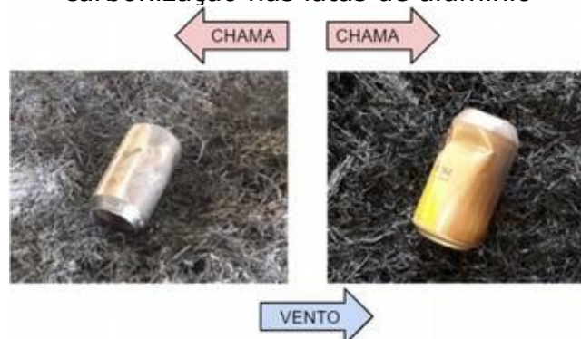
Figura 3 – Deposição de fuligem e manchas de carbonização nas latas de alumínio
