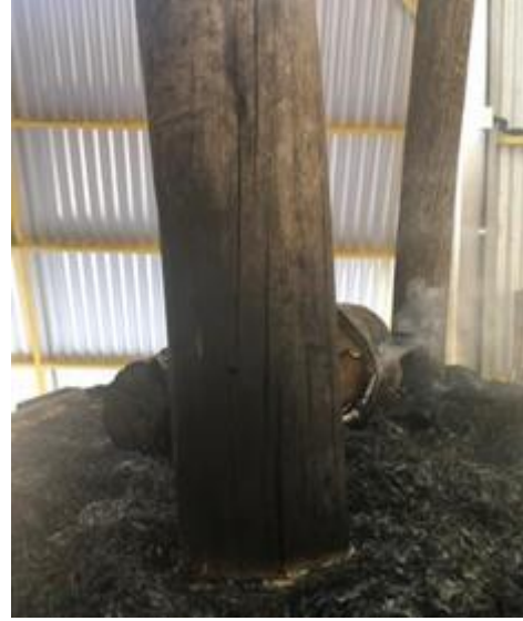
Figura 13 – Marca de combustão paralela baixa e rente ao solo.
