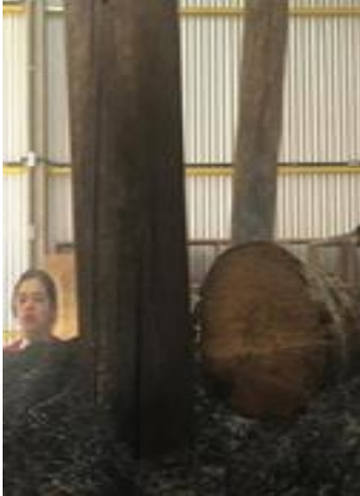
Figura 12 – Marca de combustão vertical na geratriz oposta a incidência do vento.
