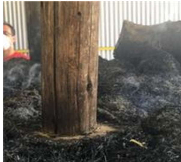
Figura 13 – Marca de combustão paralela baixa e rente ao solo.
