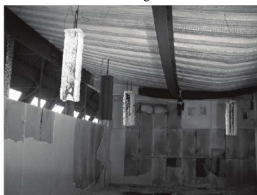
Figura 10: Compartimento após o sétimo grande teste de Cardington
