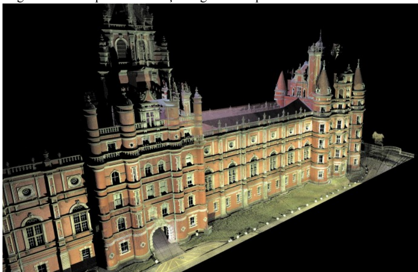
Figura 4 – Exemplo de edificação digitalizada por escaneamento a laser 3D
