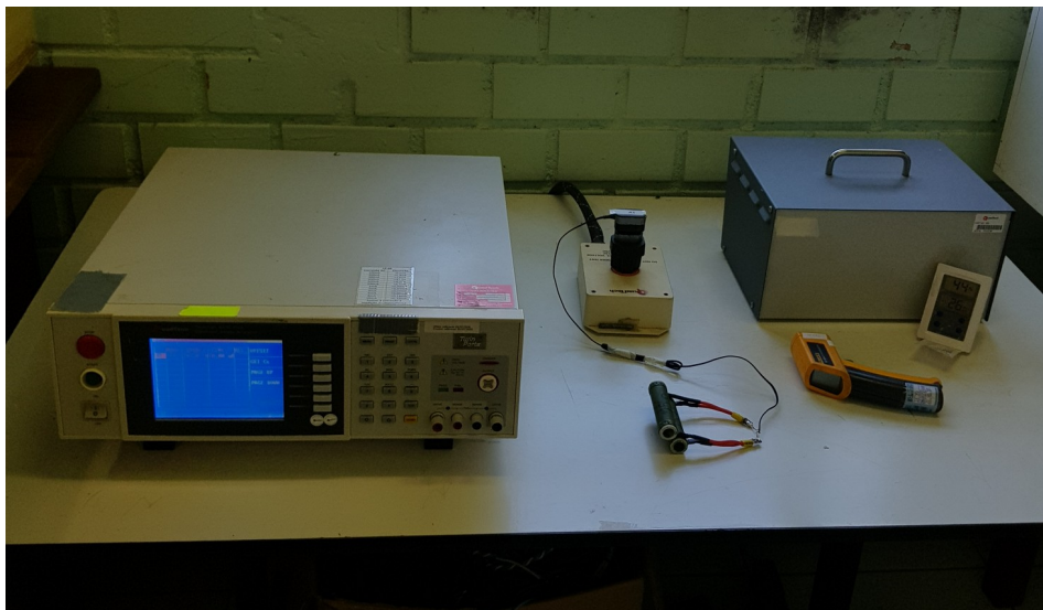
Figura 8 – Montagem do ensaio contra aquecimento excessivo.
