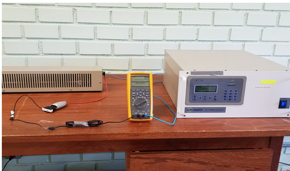
Figura 7 – Montagem do ensaio contra choque elétrico em condições de sobretensão na porta externa de energia elétrica, estando os equipamentos curto-circuitados (Chave III).
