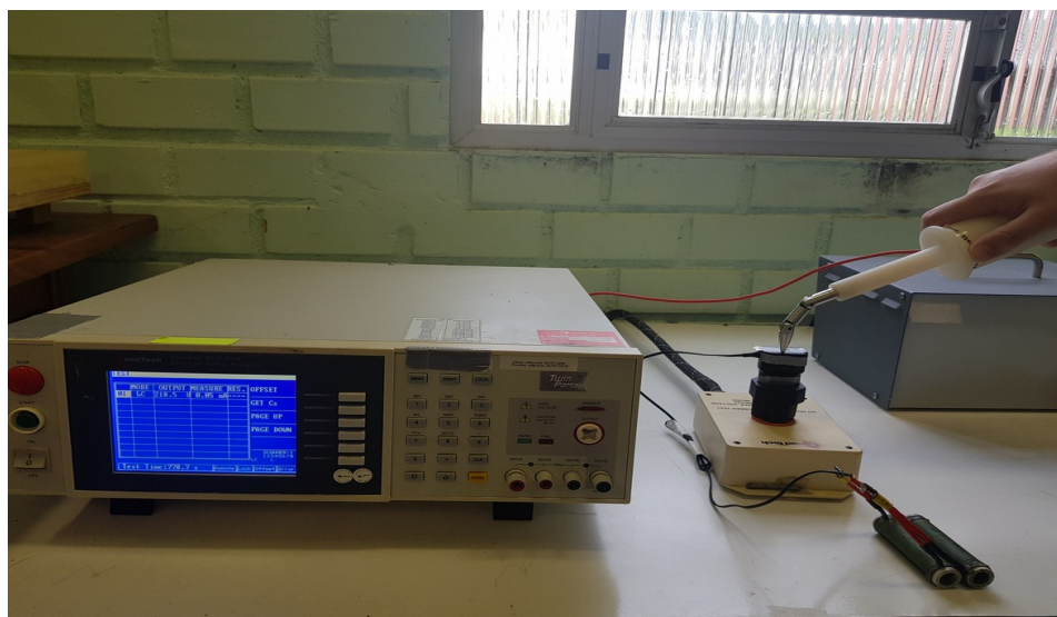
Da esquerda para a direita da foto: analisador de segurança elétrica, carregador conectado à rede de 220 V e submetido a uma carga de 7,5 \Omega , dedo artificial e transformador isolado.
