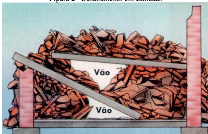
Figura 2 - Desabamento em camadas
