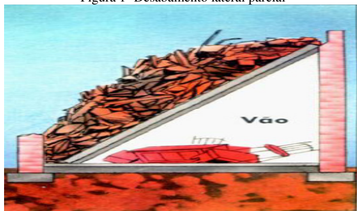
Figura 1- Desabamento lateral parcial
