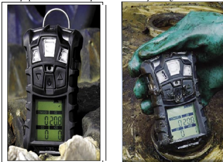
Figura 04: Equipamento utilizado para fazer a aferição de gases em ambientes confinados
