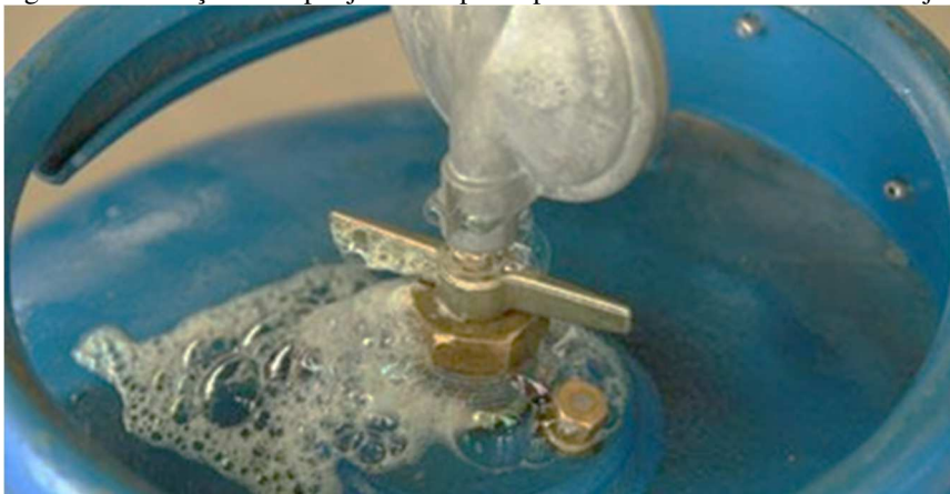
Figura 4: Utilização de esponja com espuma para verificar vazamento em botijão.
