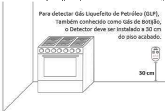
Figura 8: Local de instalação sugerida para o Detector ABAFIRE código ABGD2.
