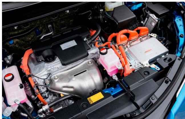
Figura 12 - Identificação do cabo laranja (alta tensão).
