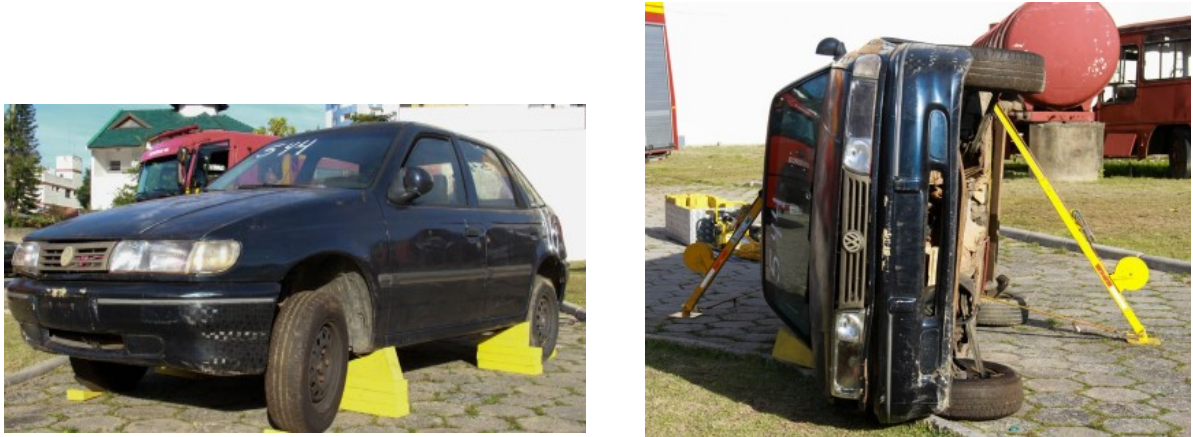
Figura 14 - Imobilização de veículos com calços e hastes.
