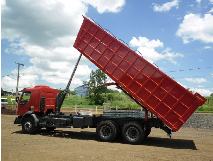
Figura 6 – Caminhão basculante, exemplo de aplicação de tomada de força com atuadores hidráulicos.
