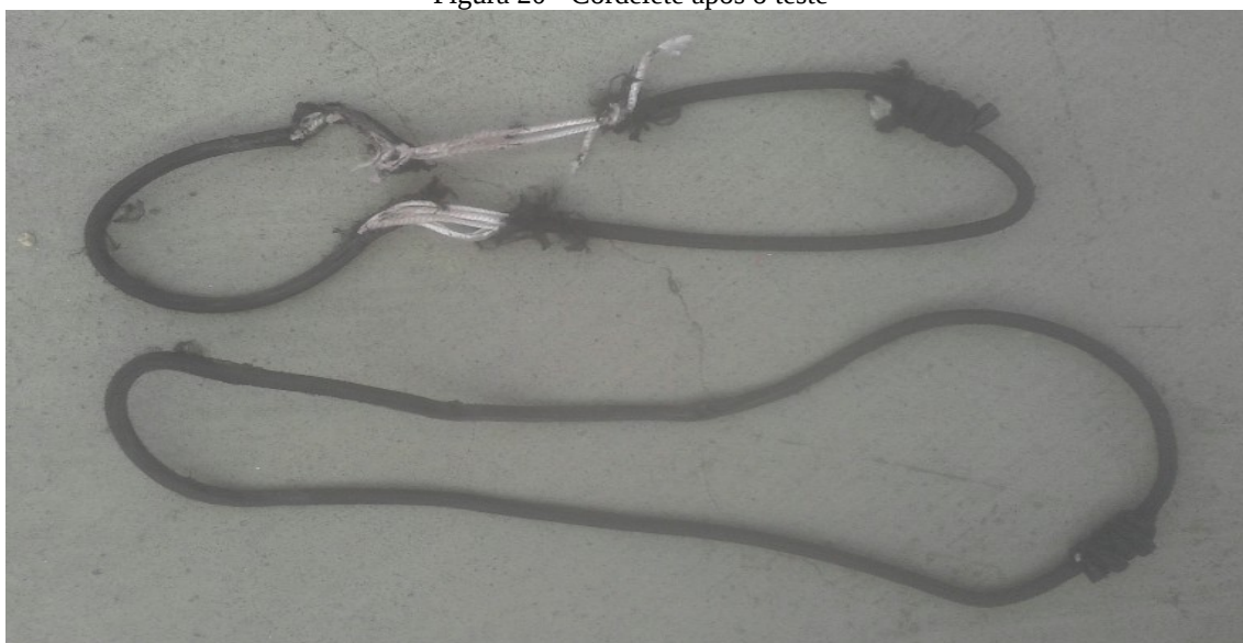
Figura 20 - Cordelete após o teste
