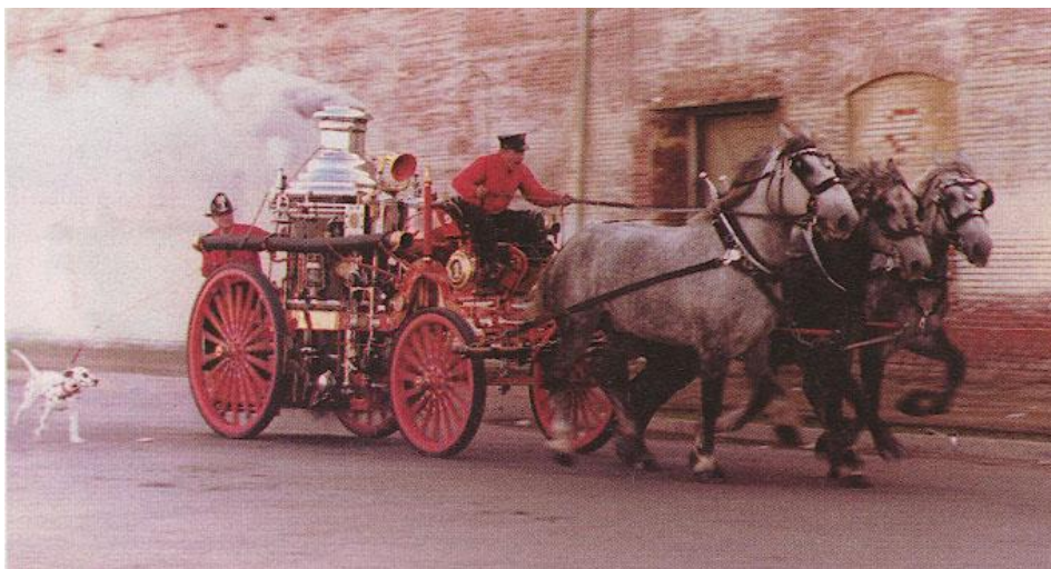
Figura 11. Bomba à vapor para combate a incêndio movida a cavalos e sendo acompanhada por um cão da raça Dálmata (à esquerda).
