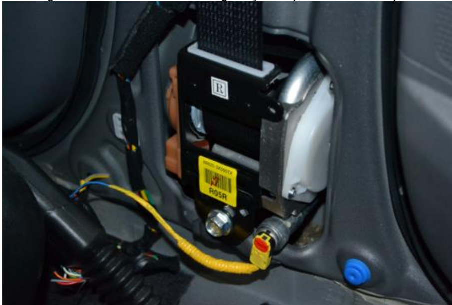
Figura 15 – Retrator de cinto de segurança com pré-tensionador exposto
