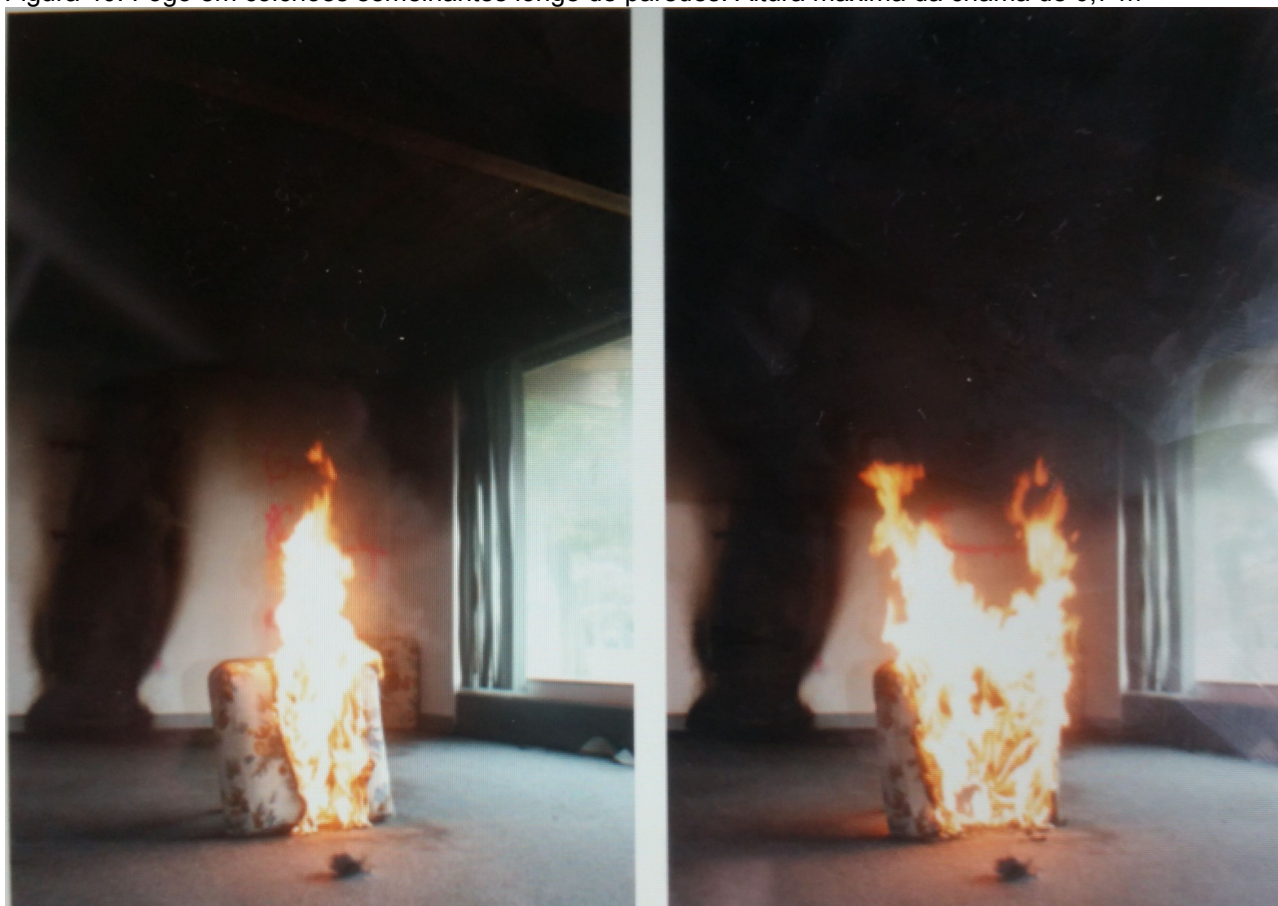
Figura 40: Fogo em colchões semelhantes longe de paredes. Altura máxima da chama de 0,7 m
