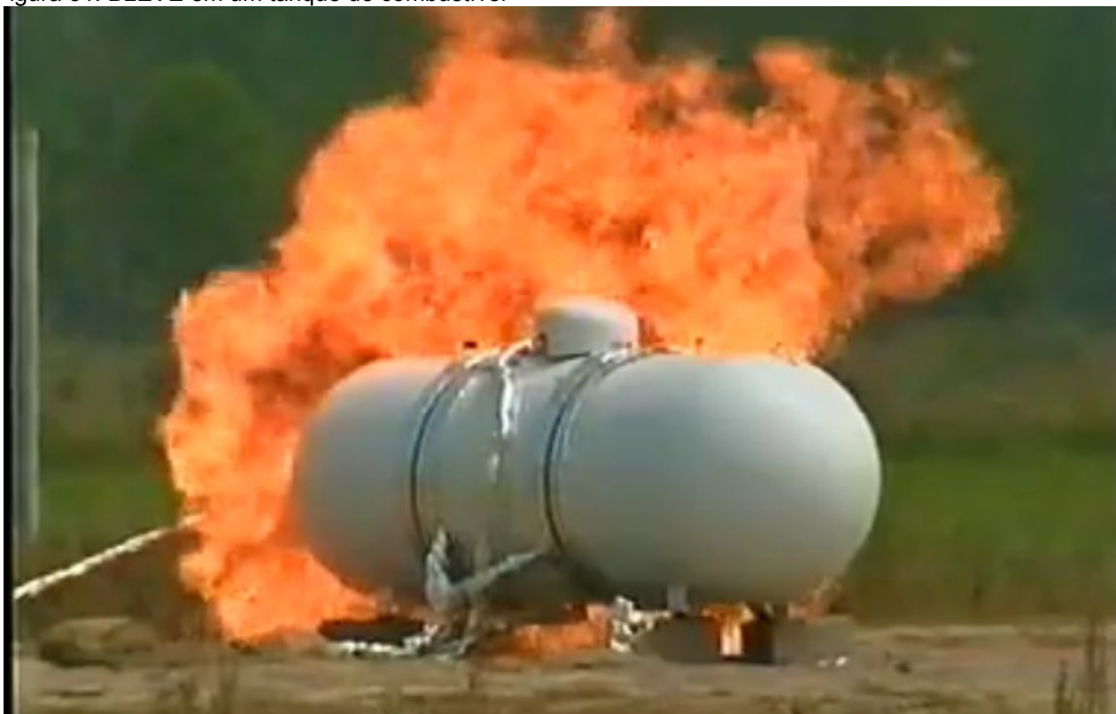
Figura 51: BLEVE em um tanque de combustível
