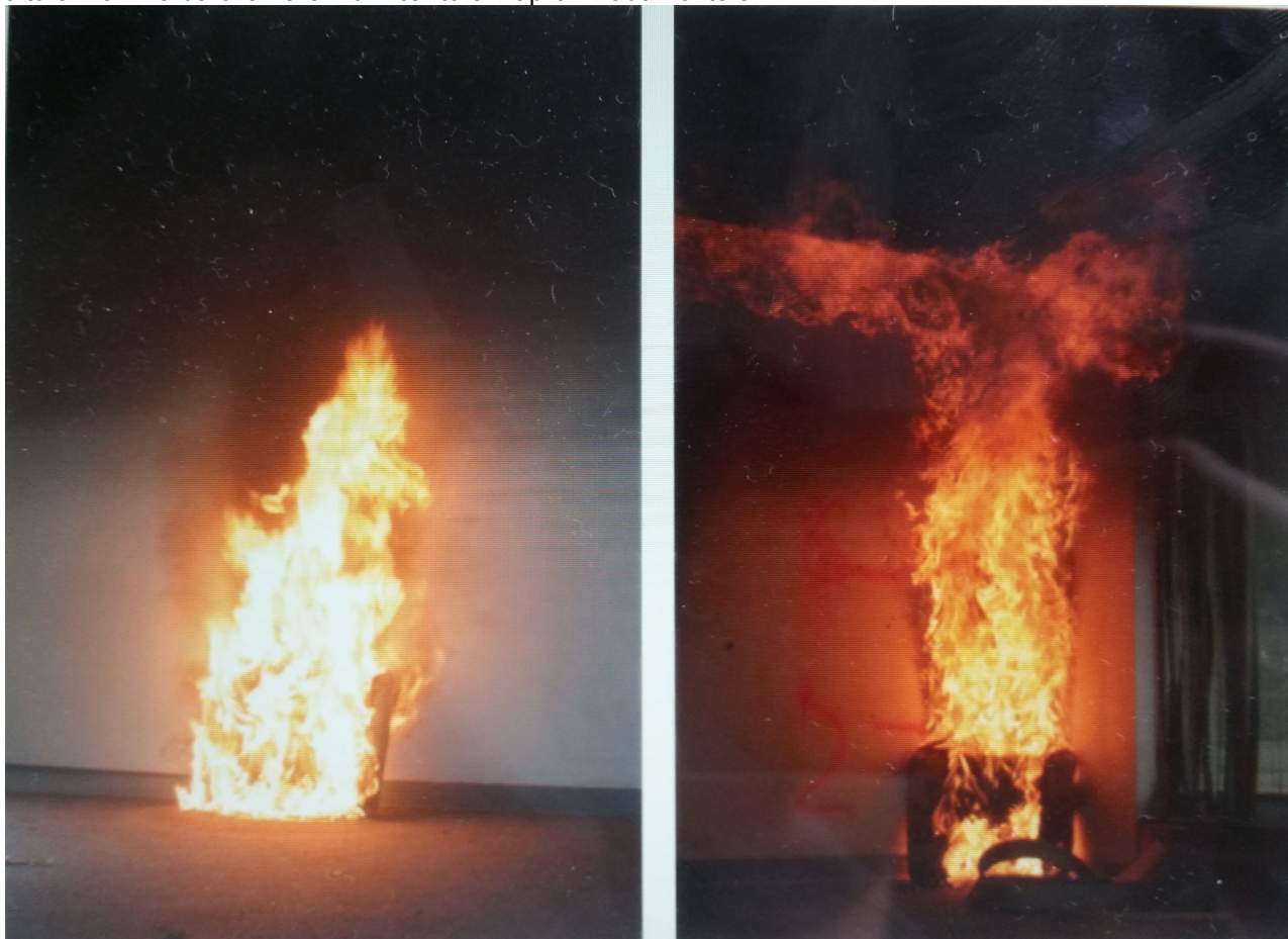
Figura 41: À esquerda altura máxima da chama contra uma parede não combustível em 1,5 m; à direita altura máxima da chama em um canto em aproximadamente 3 m
