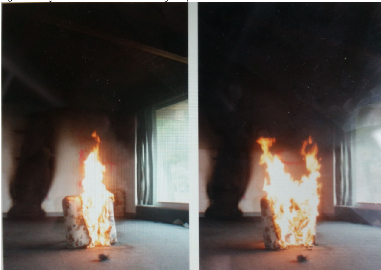
Figura 38: Fogo em colchões semelhantes longe de paredes. Altura máxima da chama de 0,7 m
