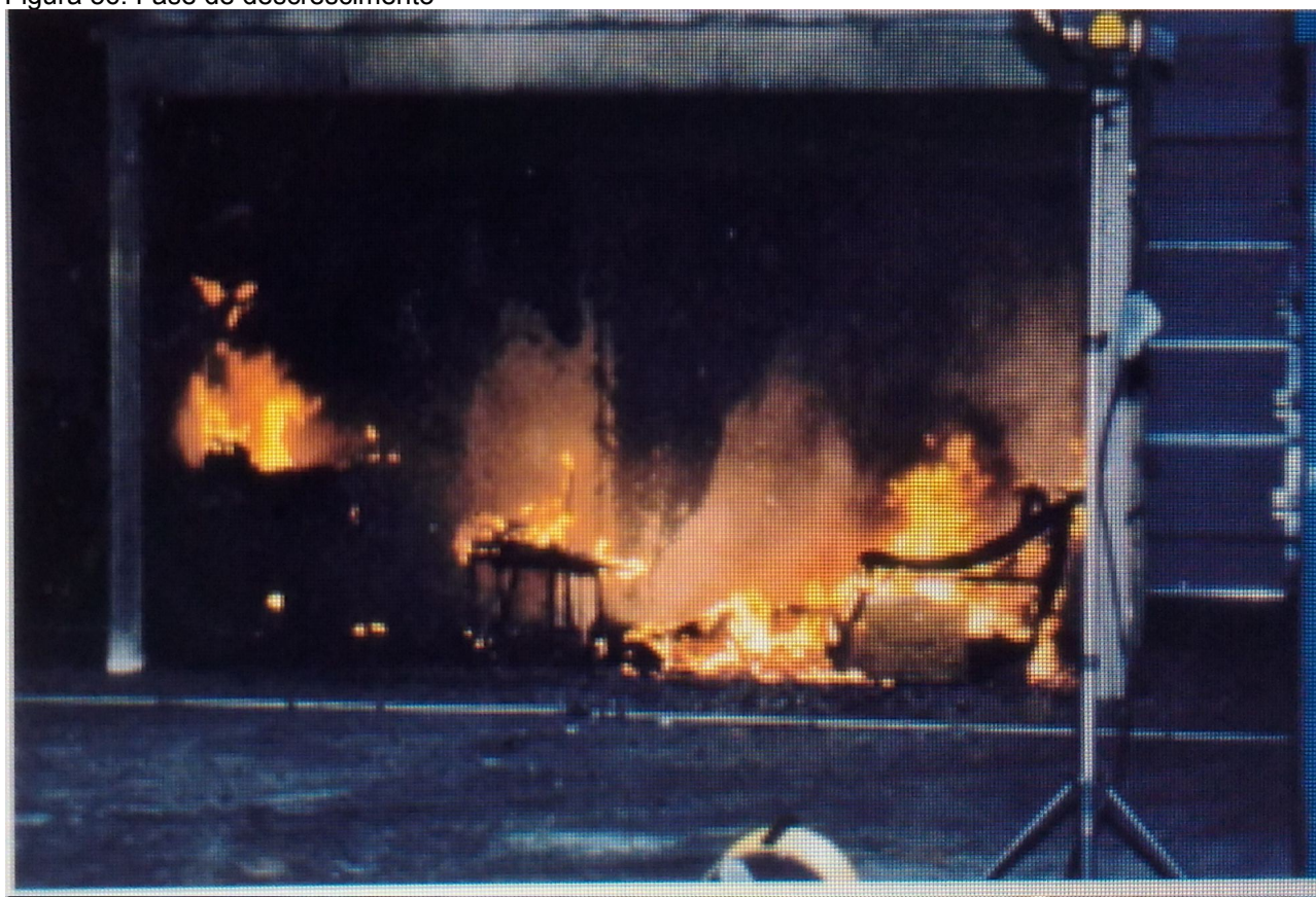
Figura 56: Fase de decaimento
