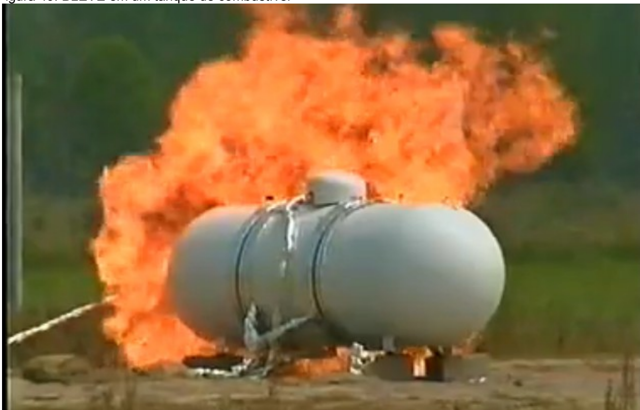
Figura 49: BLEVE em um tanque de combustível
