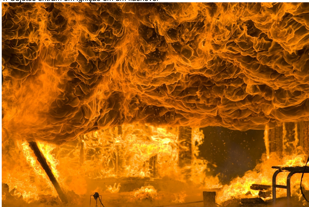
Figura 44: Objetos entram em ignição em um flashover
