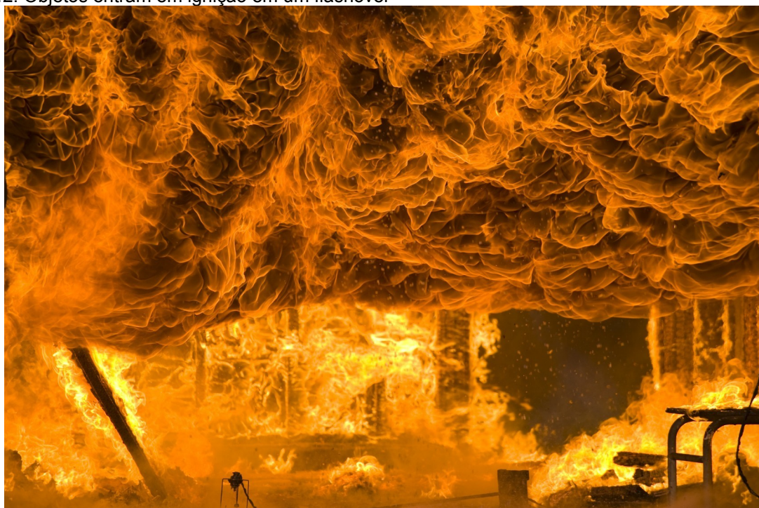
Figura 42: Objetos entram em ignição em um flashover
