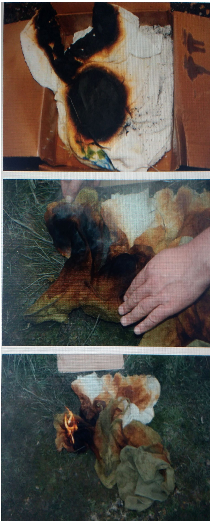
Figura 62: Trapos embebidos com óleo de linhaça entram em ignição
