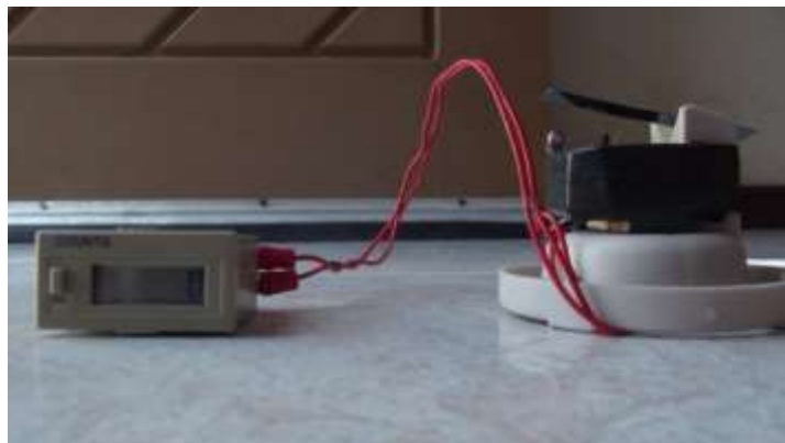
Figura 8 – Contador digital acoplado à Câmara do Manequim.
