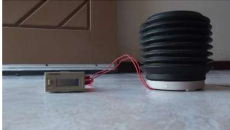
Figura 9 - Câmara do manequim com o contador digital acoplado.
