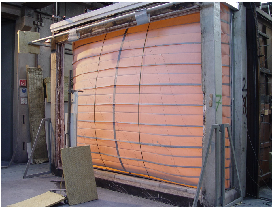
Figura 11- Abaulamento convexo na cortina de proteção contra incêndio
