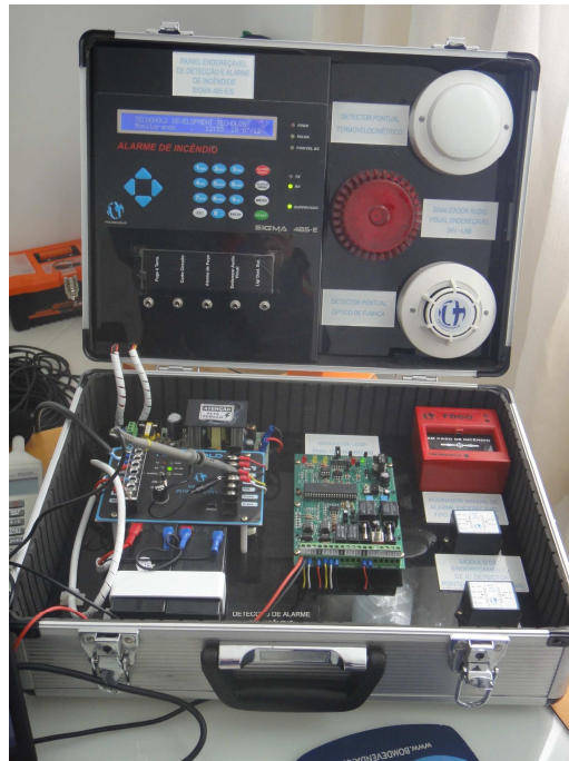
Figura 2 - Detectores automáticos e manuais e central de alarmes local
