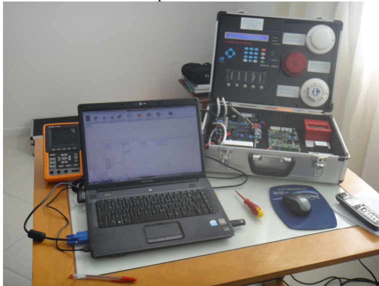
Figura 4 - Equipamento completo do Sistema Sigma 485-E - Detectores, central de alarme e Software Supervisório IRIS
