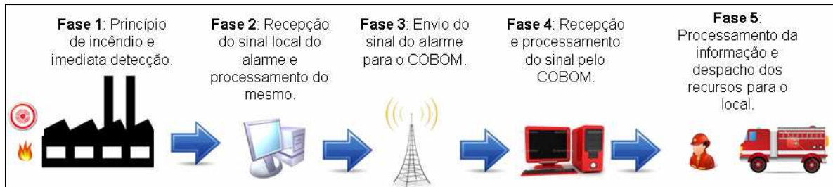
Figura 6 - Esquema do funcionamento do sistema proposto de identificação de incêndios e acionamento da resposta
