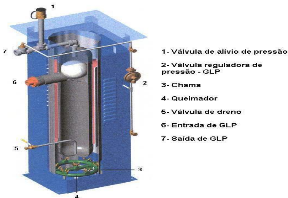
Figura 5 - Vaporizador de chama direta
