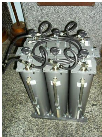
Figura 5: Filtro de cavidades para repetidoras.
