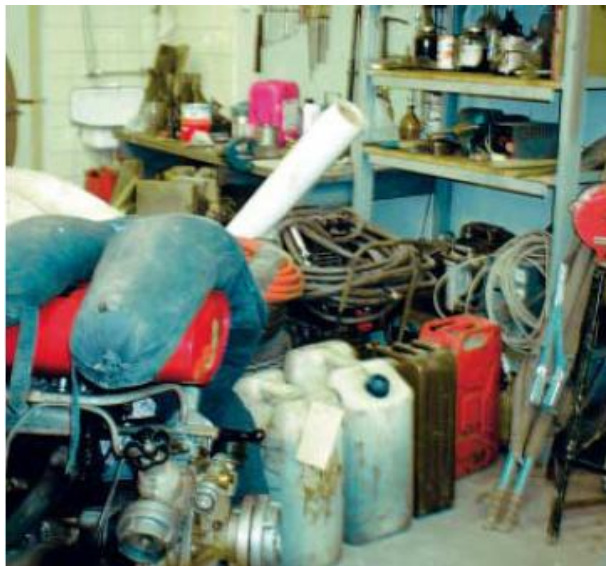
Figura 14 – Organização inadequada de uma oficina
