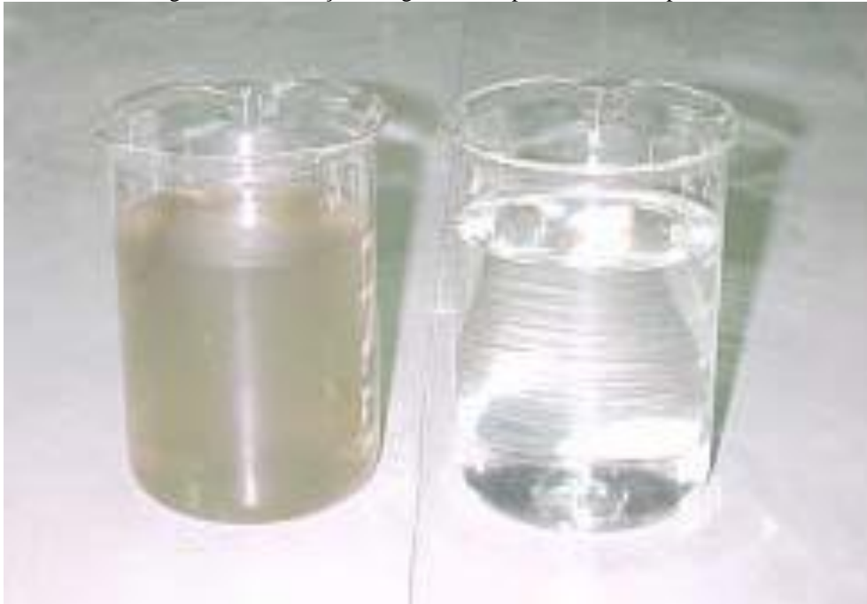
Figura 4: Clarificação da água tratada pelo sistema FF piloto.
