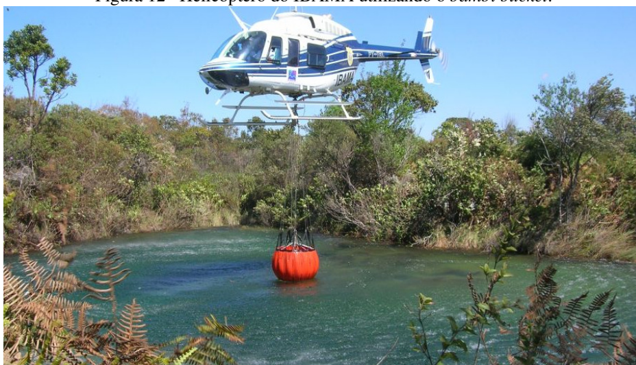
Figura 12– Helicóptero do IBAMA utilizando o bambi bucket .
