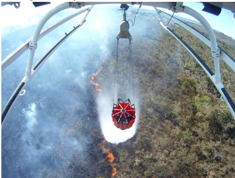
Figura 7 – Helicóptero combatendo incêndio com bambi bucket
