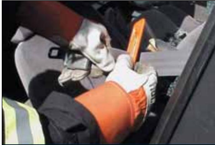
Figura 1: Resgate leve – corte do cinto de segurança que prende a vítima.
