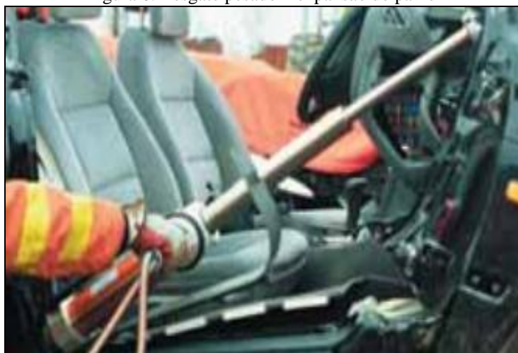
Figura 6: Resgate pesado – expansão do painel
