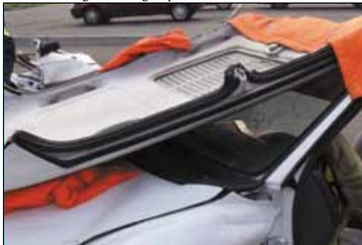
Figura 4: Resgate pesado – retirada do teto
