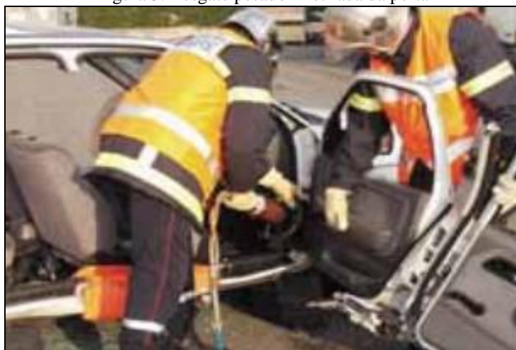
Figura 5: Resgate pesado – retirada da porta
