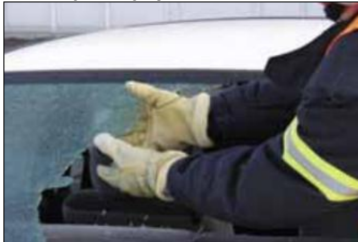
Figura 2: Resgate pesado – retirada dos vidros
