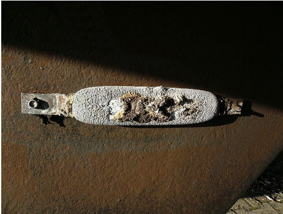
Figura 26: Exemplo de proteção galvânica. Metal de sacrifício parcialmente corroído ligado ao casco de um navio.
