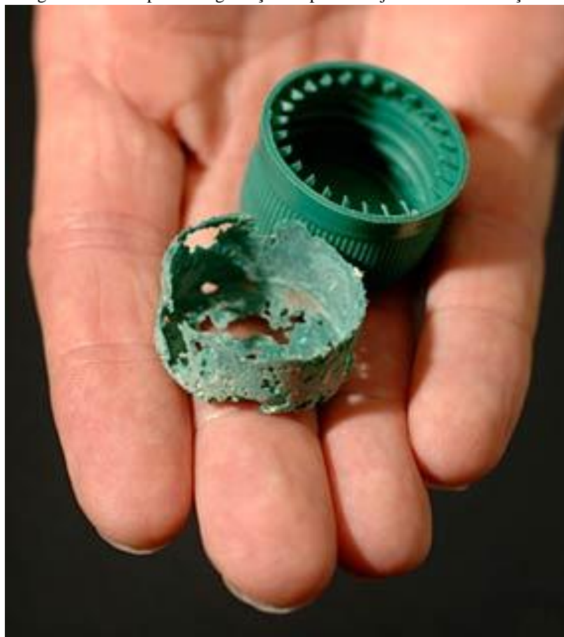
Figura 27: Exemplo de degradação de polímero já em estado avançado.
