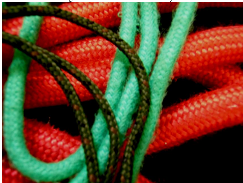
Figura 19: Cordas fabricadas em nylon.
