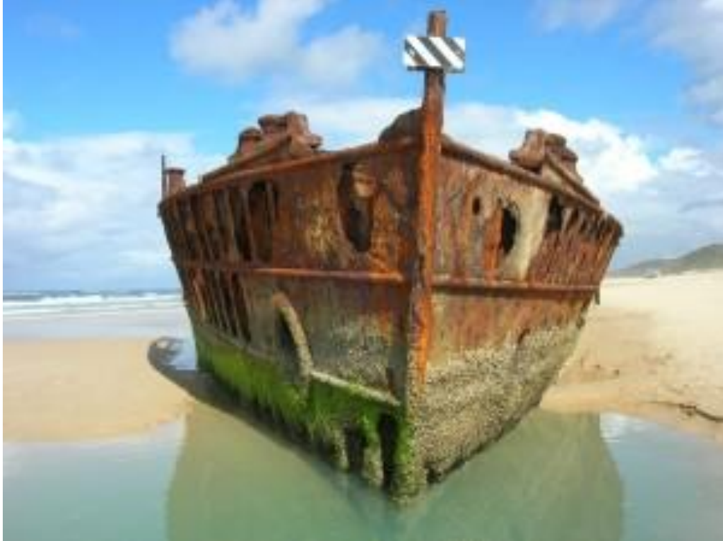
Figura 25: Exemplo de embarcação de aço encalhada na praia, corroída pela ação das intempéries.
