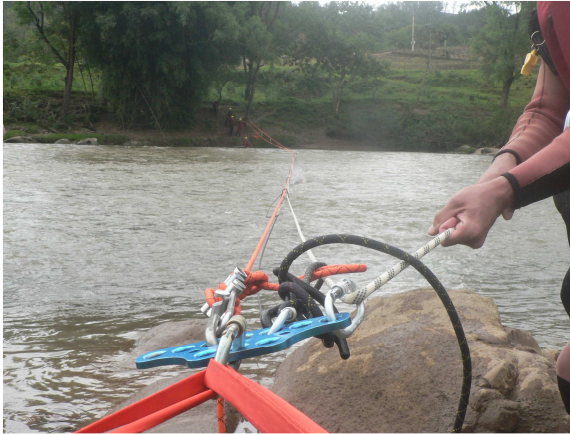
Sistema de ancoragem e tracionamento à direita do rio
