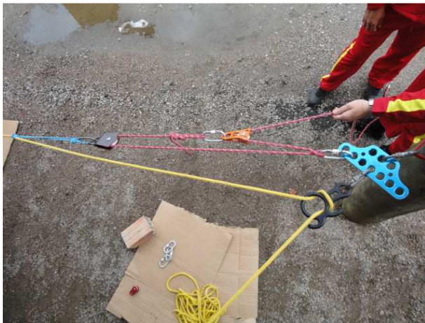
Sistema de tracionamento independente (Pig-Rig 4:1)
