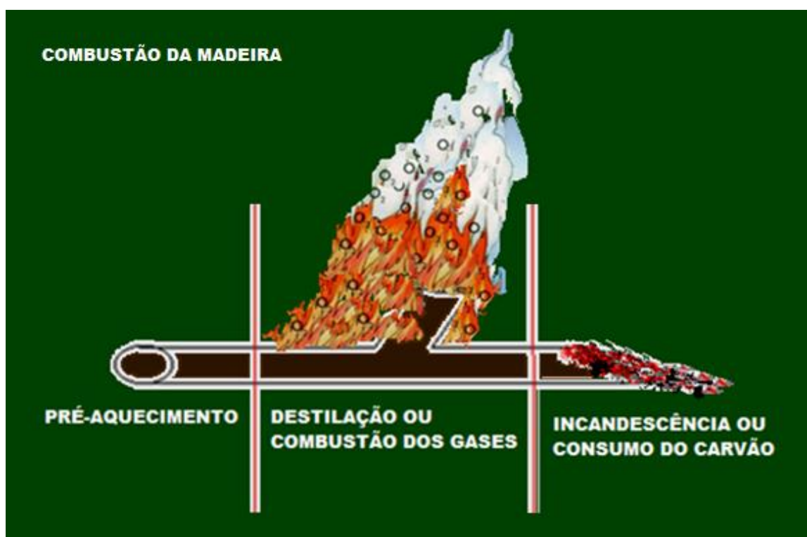
Figura 2: As três fases da combustão dos vegetais, no incêndio florestal de superfície.
