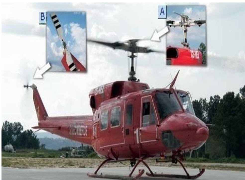
Foto 6: Rotores de um helicóptero. A – Rotor principal; B – Rotor de cauda. Fonte: Parola et al. (2003).
