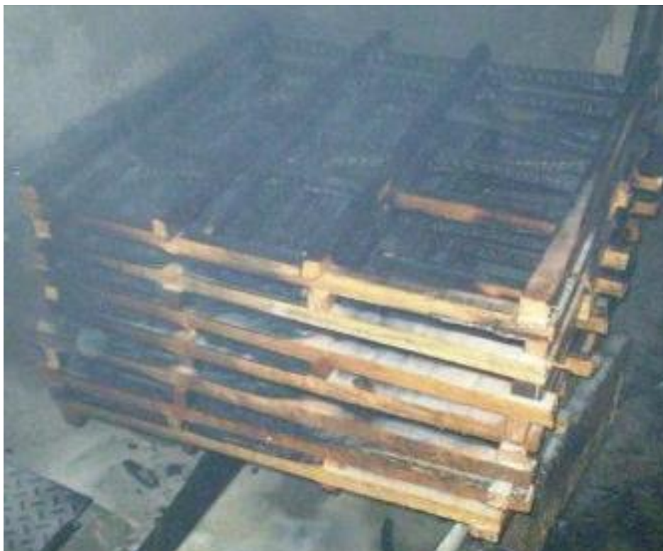
Foto 57: Camada de gel sobre as ripas do engradado. Fonte: do autor.
