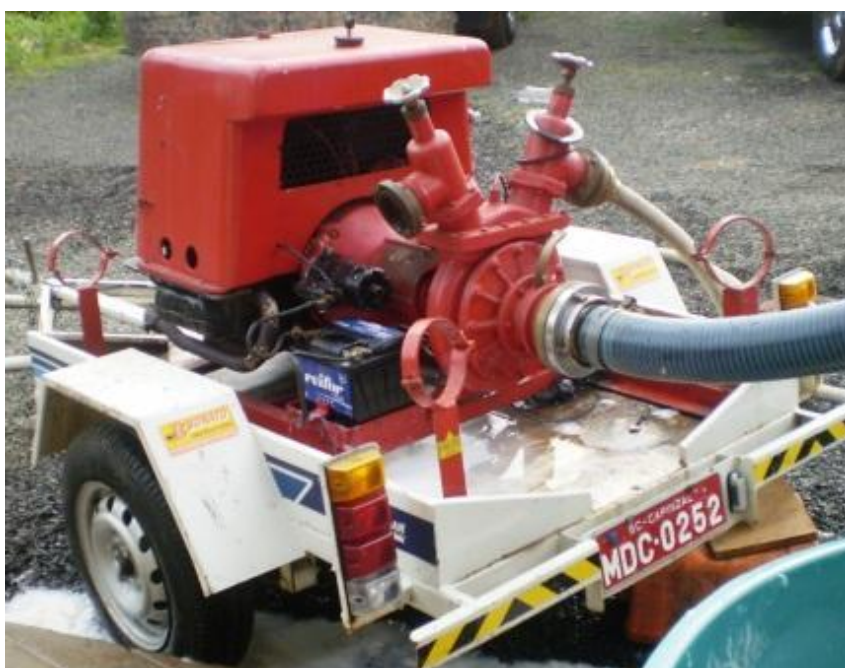
Fotos 19 e 20: Bomba-reboque. Fonte: do autor.
