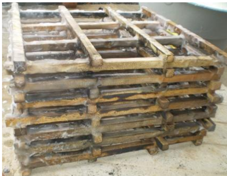
Foto 50: Lado mais exposto ao fogo. Fonte: do autor.
