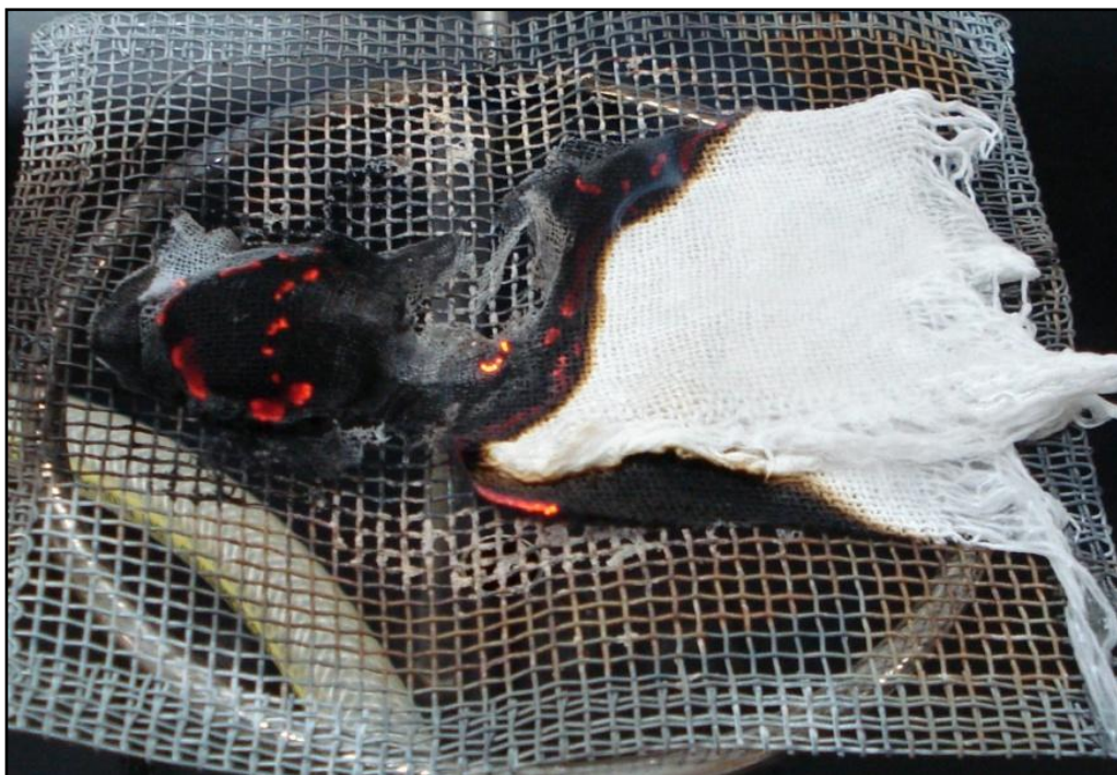
Foto 35: Resultado final da combustão do tecido. Apenas a parte umedecida com água foi carbonizada até o fim.
