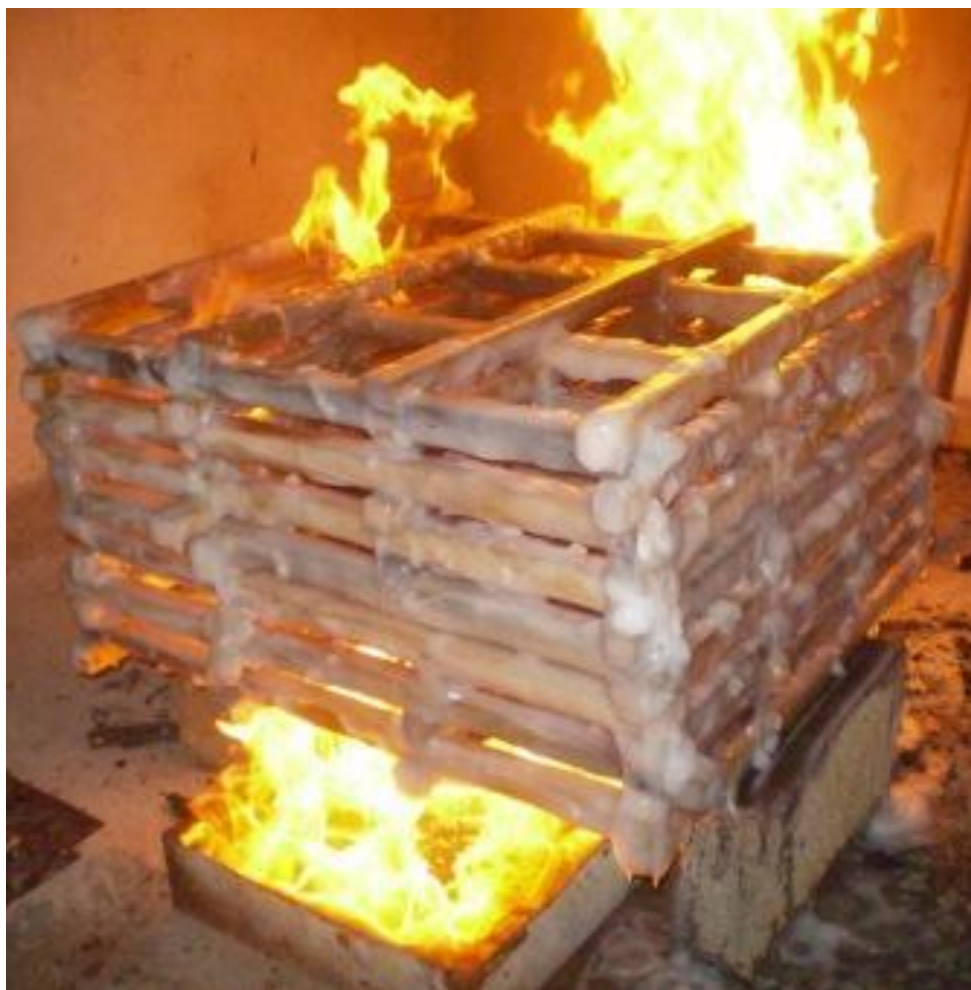
Foto 46: Engradado sendo submetido às chamas. Fonte: do autor.
