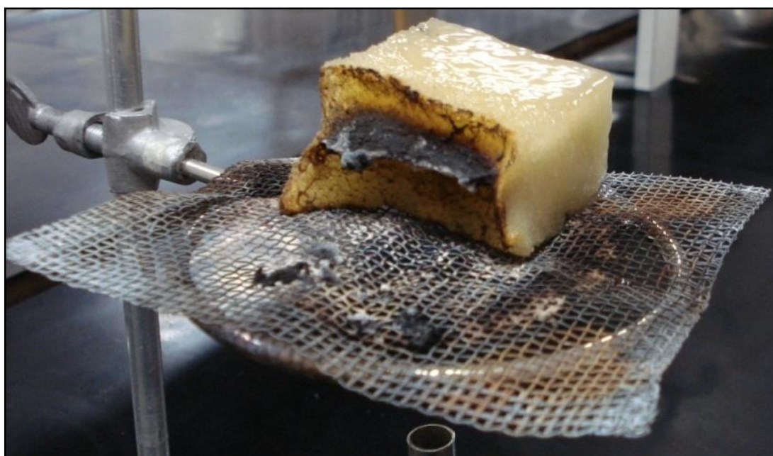
Foto 37: Espuma seca completamente queimada. Fonte: do autor
