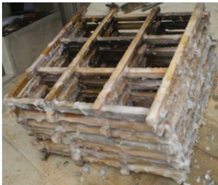
Foto 49: Engradado após teste de retardância com 3%. Fonte: do autor.
