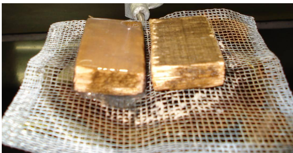
Foto 3: Amostra de madeira com a mistura à 3% e outra amostra molhada com água. Fonte: do autor.
