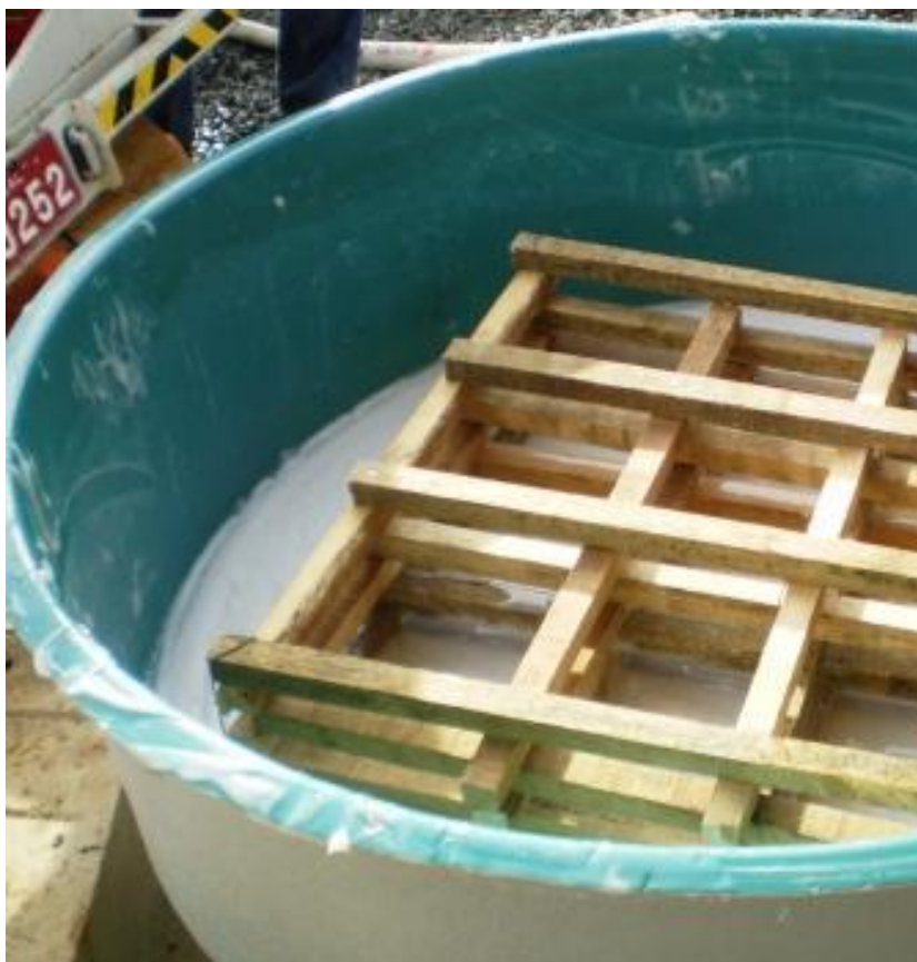
Foto 45: Engradado sendo submergido no gel com 3% de concentração. Fonte: do autor.
