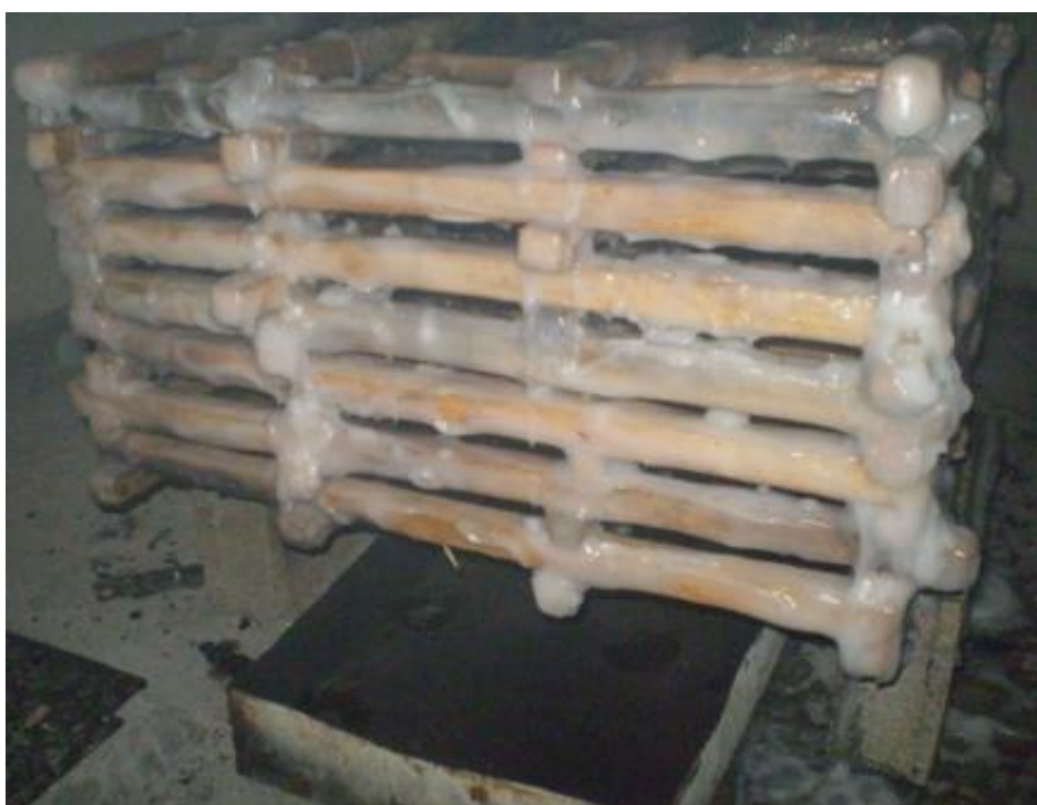
Foto 48: Engradado ainda com gel, ao final do teste de retardância. Fonte: do autor.
