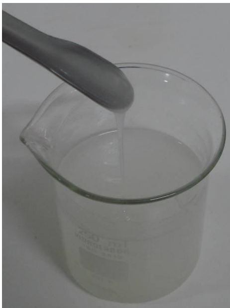
Foto 2: Viscosidade da mistura a 0,75% de Barricade Fire Blocking Gel® e água. Fonte: do autor.
