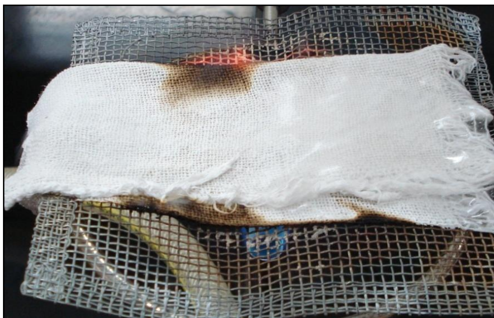
Foto 34: Início da queima do tecido na parte que estava molhada com água. Fonte: do autor.
