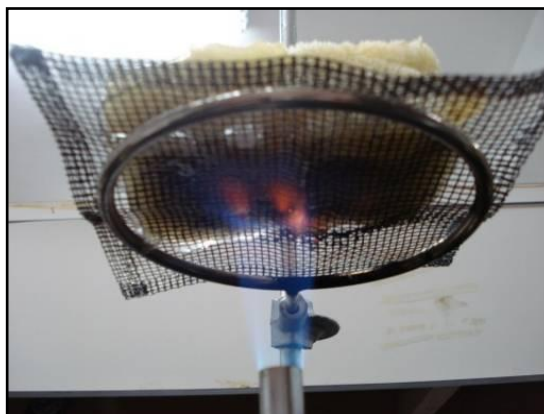
Foto 7: Chama posicionada bem ao centro da espuma. Fonte: do autor.
