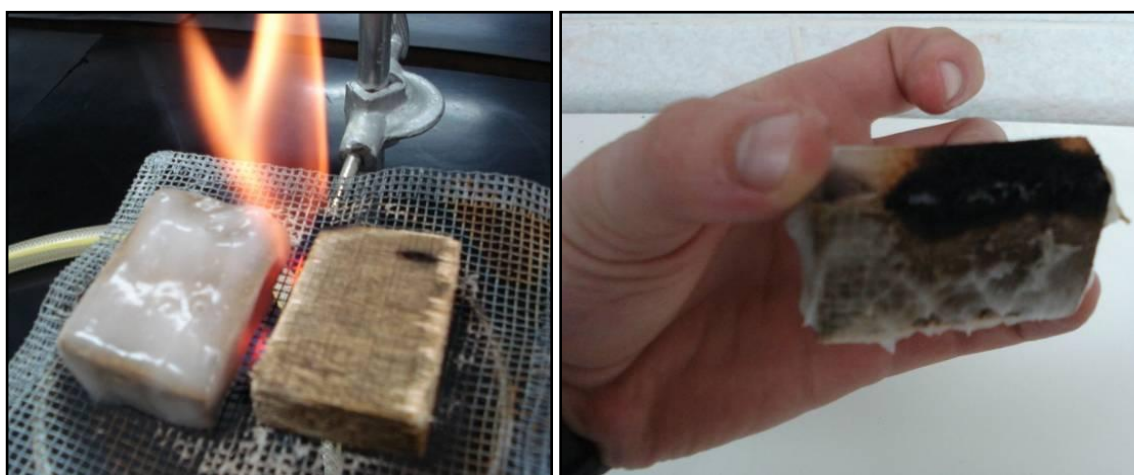
Fotos 32 e 33: Parte da amostra a 3% que sofreu carbonização externa (parte mais próxima da outra amostra e diretamente sob as chamas).
