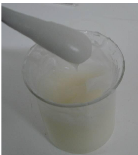
Foto 1: Viscosidade da mistura a 3% de Barricade Fire Blocking Gel® e água. Fonte: do autor
