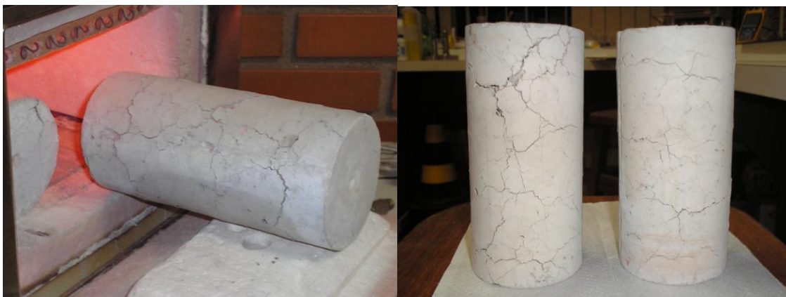
Figura 17 – Rachaduras e pigmentação rosácea (esq.) dos corpos de prova a 700°C.
