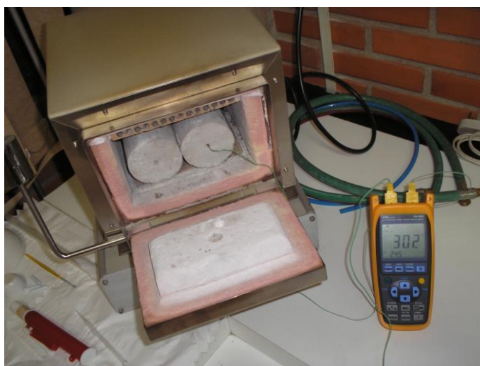
Figura 14: Mufla, corpo de prova, termostato e termômetro instalados.
