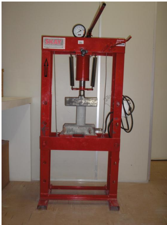
Figura 15: Prensa com corpo de prova posicionado para início da compressão.
