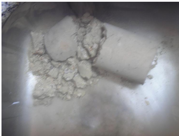
Figura 18 – Corpo de prova desintegrado pela ação do choque térmico com água.
