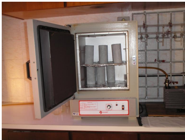
Figura 13: Corpos de prova na estufa a 60°C.
