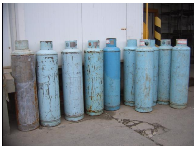
Foto 15 – Cilindros que armazenam amônia líquida pressurizada
