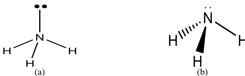
Figura 4 – Estrutura química da amônia - (a) o par de elétrons livres e (b) a estrutura tridimensional da molécula.
