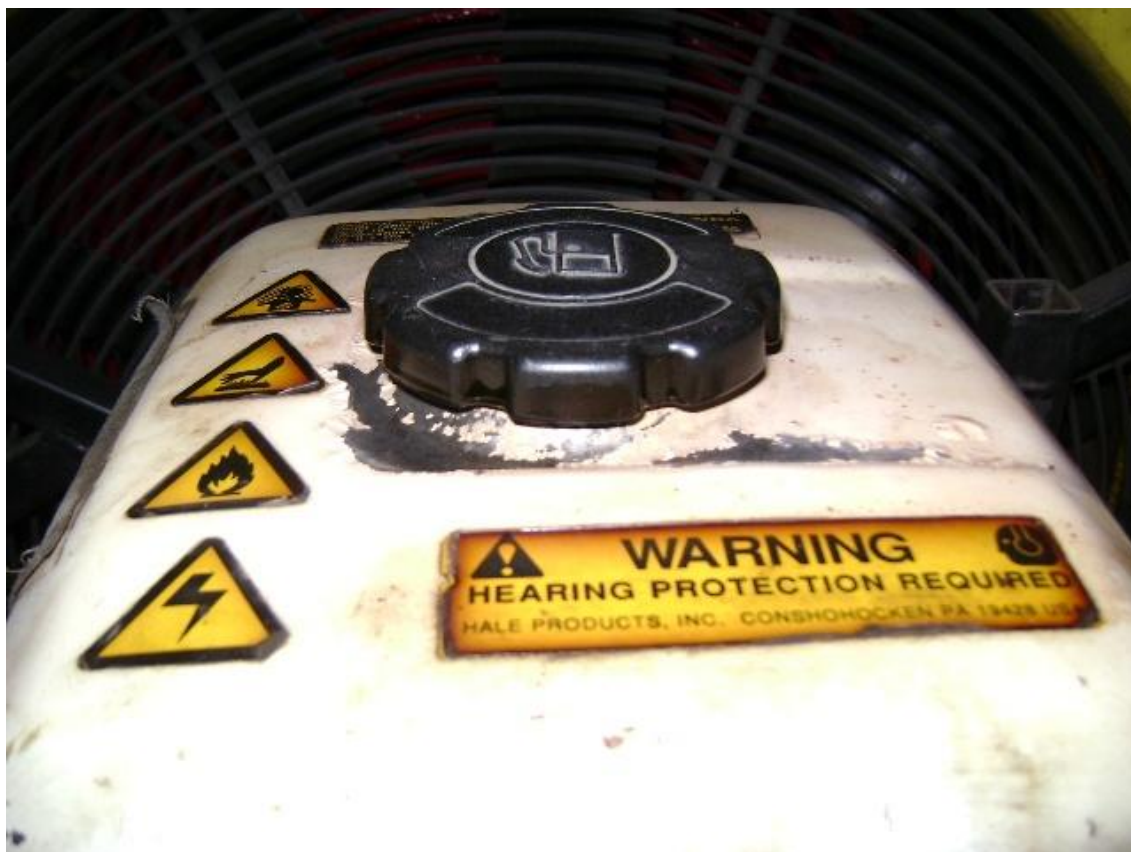
Foto 1: Motor do aparelho de ventilação/exaustão usado em combate a incêndio.
