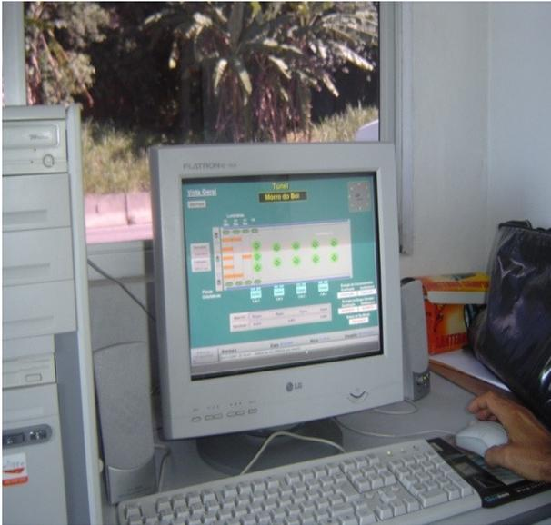
Figura20- Programa para controle da ventilação
