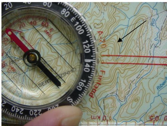
Figura 9 - Aferição do azimuth
