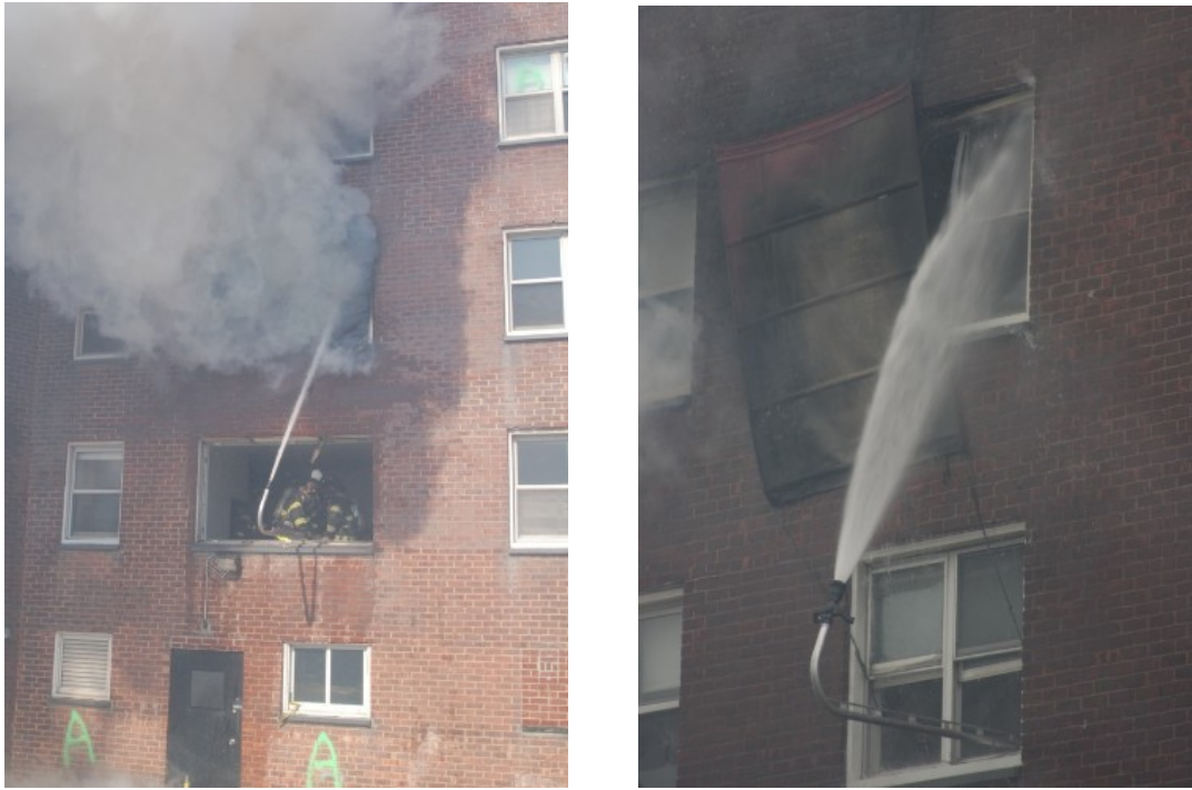
Figura 20 - Esguicho para edificações de grande altura e sua aplicação.
