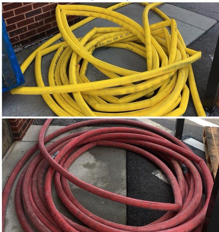
Figura 9 - Pressurização inadequada (mangueira amarela) do cleveland load em função da baixa pressão disponível.
