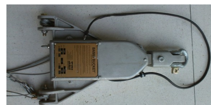
Unidade de Comando Elétrico
