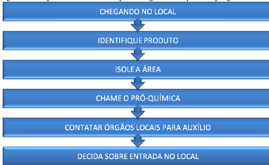
Figura 12 – Sequência de atendimento para emergência com produtos perigosos
