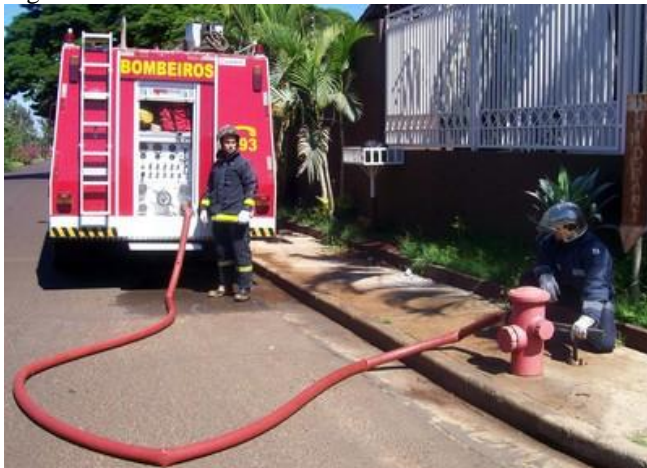
Figura 4 - Bombeiro realizando reabastecimento do caminhão em hidrante público.
