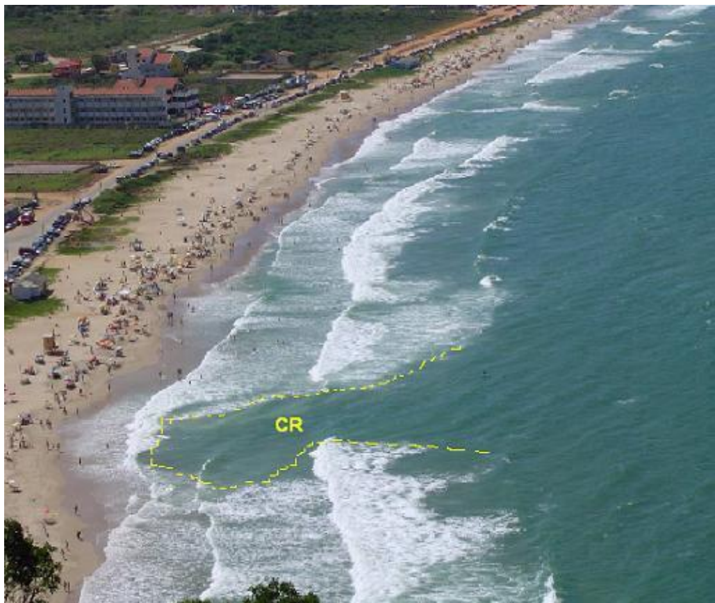
Figura 1 - Corrente de retorno - superfície da água sem a presença de quebra de ondas, devido a profundidade do canal.
