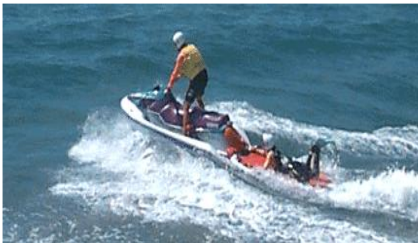
Figura 17 – PWC montado com o Sled.
