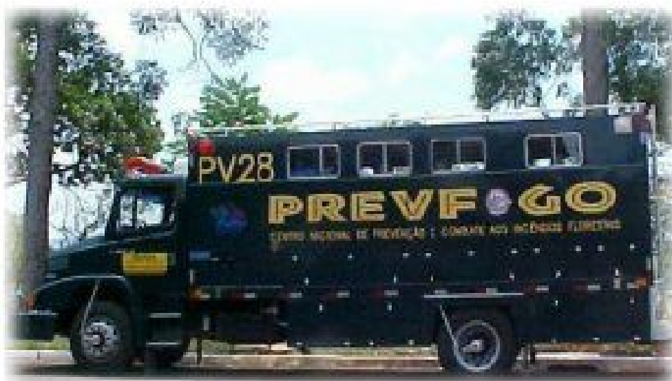
Figura 11: veículo de transporte de bombeiros e equipamentos contendo 3000 litros de água
